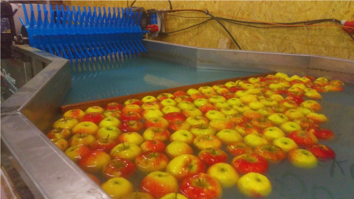
Bild 1: Putzstraße – Wasserbecken, vor der eigentlichen Bürstmaschine
