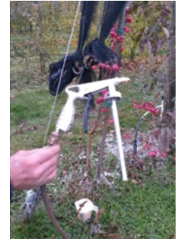
Abbildung 9: Spritzauf-satz für Kalkmilch-aus-bringung
